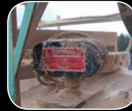
Midiendo aserrín en una fábrica manufacturadora de productos de madera.
